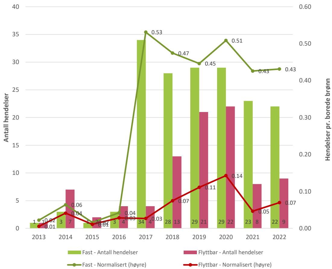
Figur 10-16 Antall hendelser i boreområder med energi <40 J, fordelt på faste og flyttbare innretninger, samt normalisert mot antall borede brønner pr år, for perioden 2013-2022
