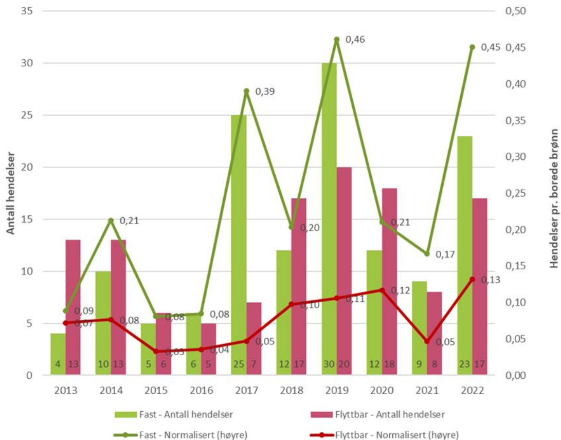
Figur 10-17 Antall hendelser i boreområder med energi >40 J, fordelt på faste og flyttbare innretninger, samt normalisert mot antall borede brønner pr år, for perioden 2013-2022
