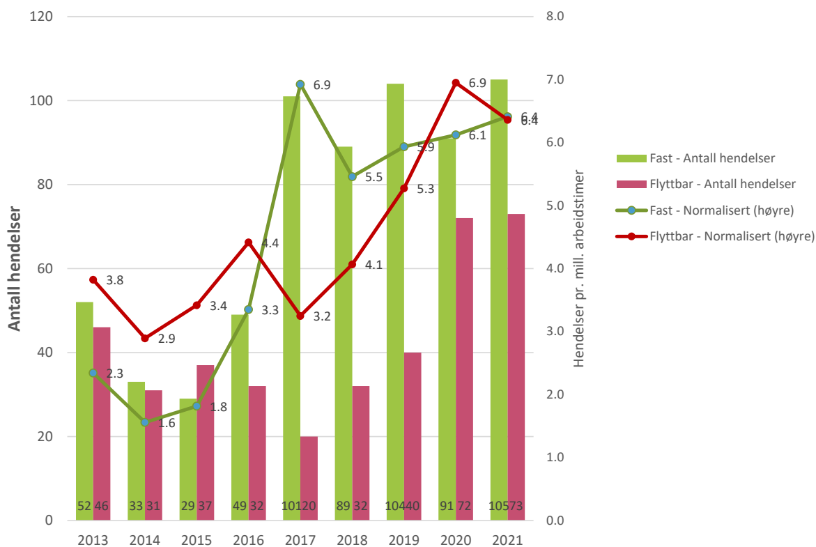
Figur 9.1 Antallet innrapporterte hendelser for kran- og løfteoperasjoner i perioden 2013-2021 vist for faste og flyttbare innretninger – absolutt antall og antall normalisert mot millioner arbeidstimer relatert til bore- og brønnoperasjoner og til konstruksjon og vedlikehold, per type innretning
