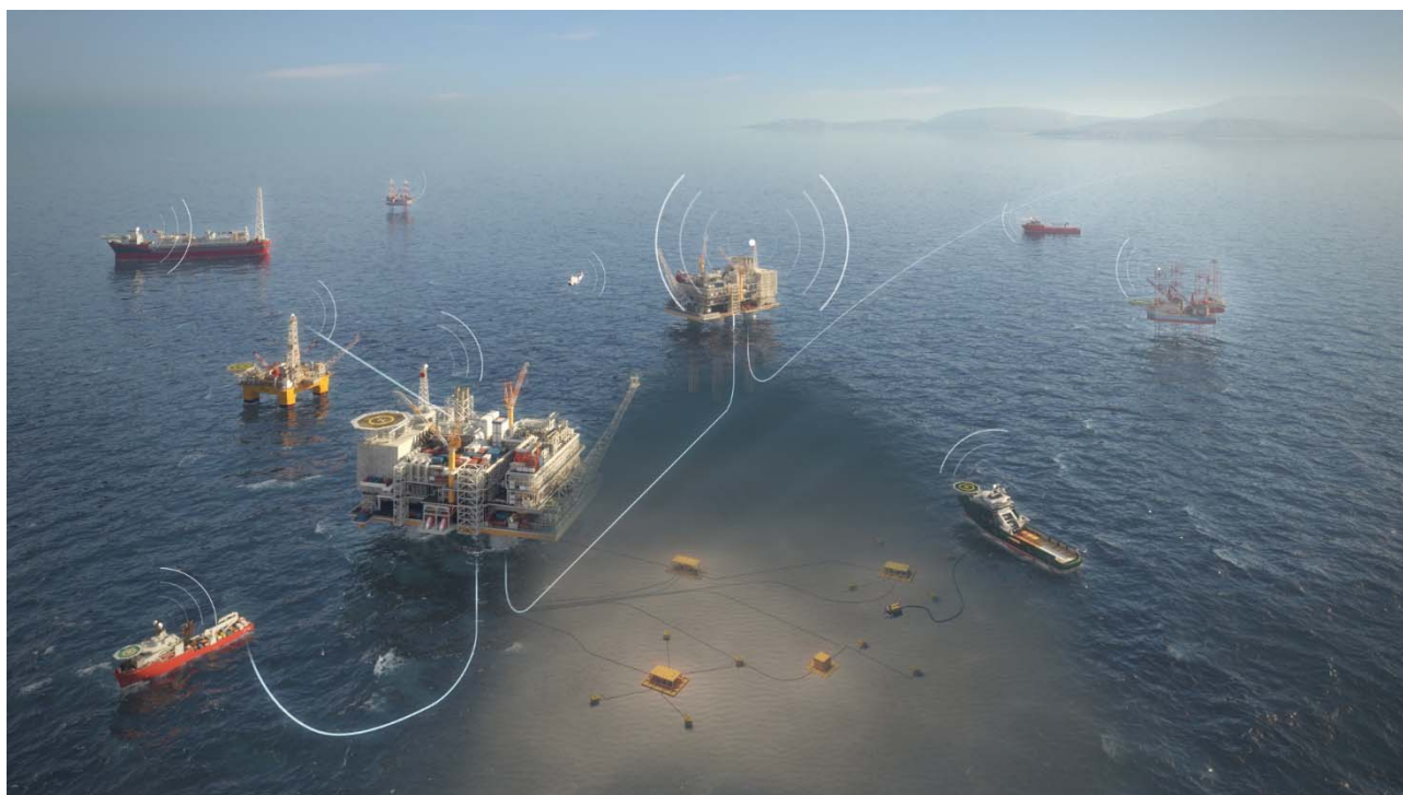
Figur 2.3 Illustrasjon av fiberkabel-, radiolinje- og 4G/LTE-forbindelser (Bilde: Tampnet)
