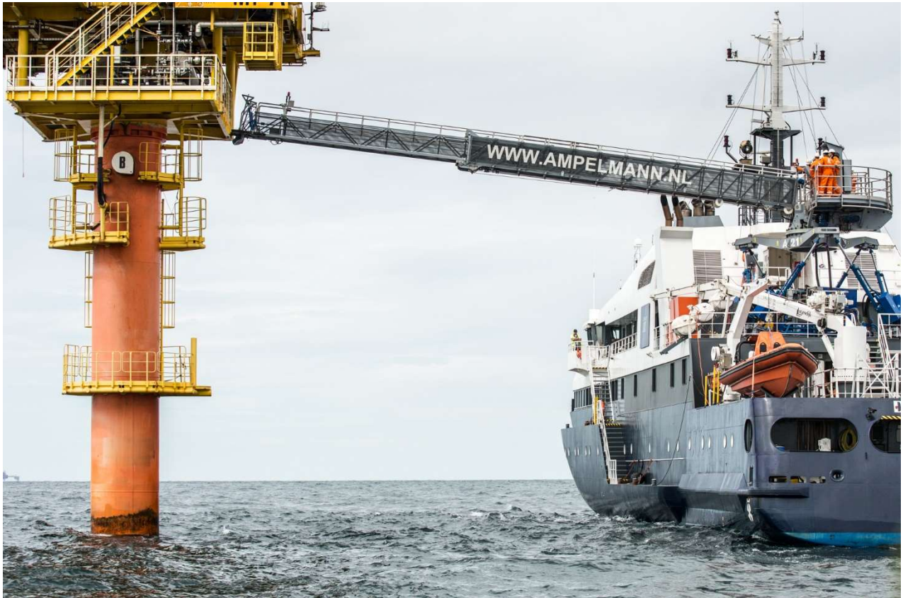
Figur 8-1 Ampelmann gangbrosystemet i bruk. (Bilde brukt etter avtale med Ampelmann Operations B.V.)
