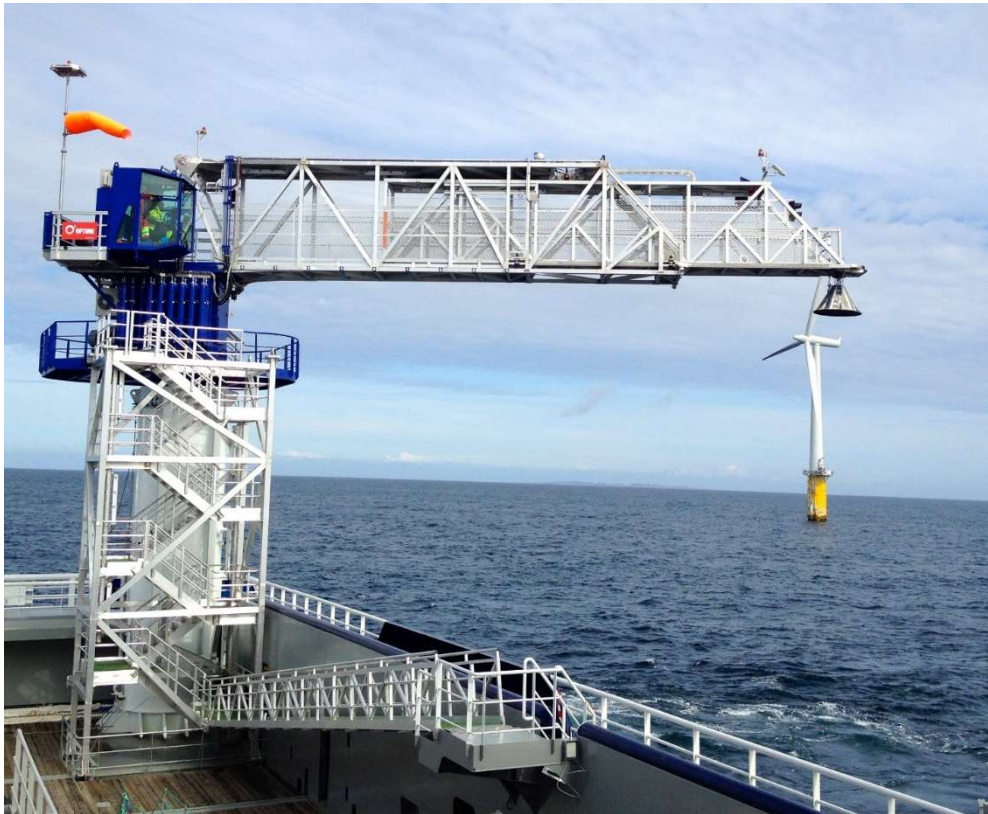
Figur 8-4 Uptime gangbro på WTW Island Crown, noe mindre enn Marine Aluminium gangbro. Bildet viser også pidestallen som gangbroen står på og teleskopprinsippet for selve gangbroen. (Bilde brukt etter avtale med Marine Aluminium.)
