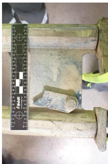
Figur 14. Vange med brudd nedre feste.
