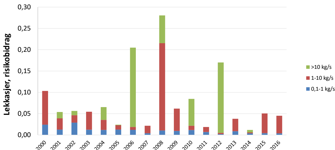
Figur 29 Risikobidrag fra lekkasjer vektet ut fra risikopotensial
