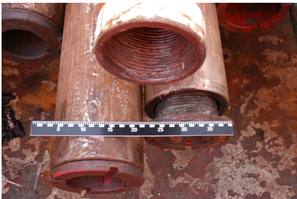
Bilde 4: Bilde fra skadested som viser rør som falt og en halvveis innskrudd protektor på drill collar.
