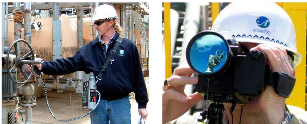
Figur 8-13 Venstre: flammeionisasjonsdetektor. Høyre: avansert optisk gassavbildningssystem (Optical Gas Imaging (OGI) system) (ref. /51/)
