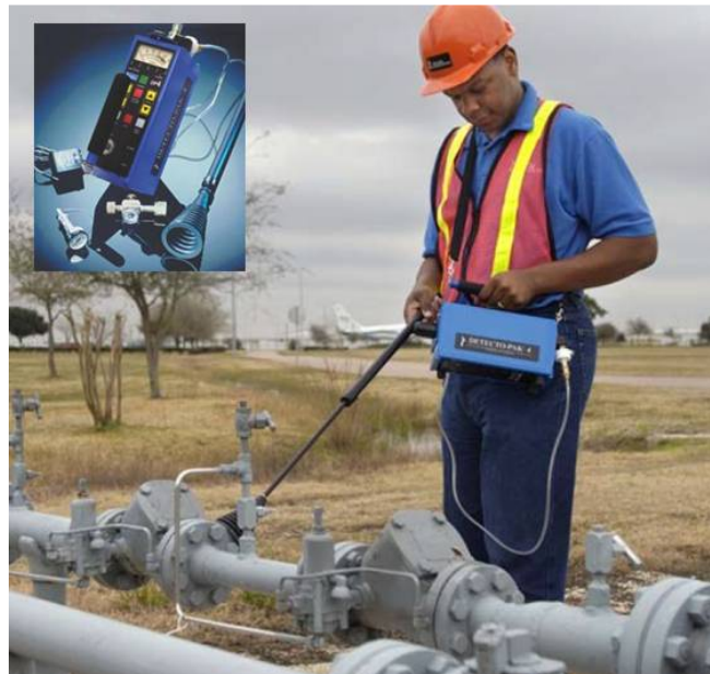
Figur 8-11 Bærbar FID gasslekkasje-detektor (Ref. / 60 /)
