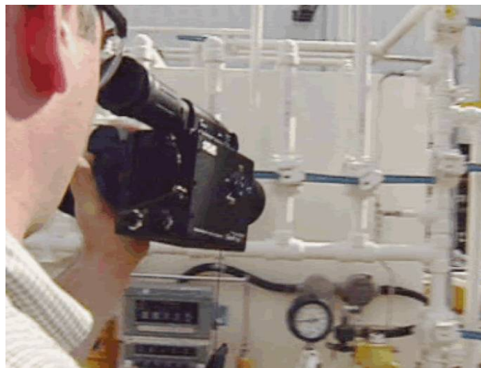
Figur 8-12 Infrarødt kamera for deteksjon av små lekkasjer (ref. / 61 /)
