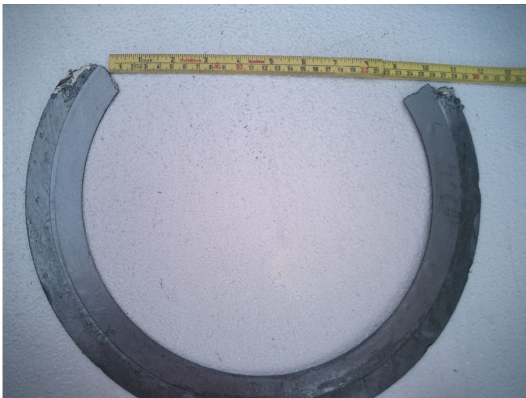
Bilde 1. Rest av pakning. Pakning utblåst mellom kl 10 og 2:30.
