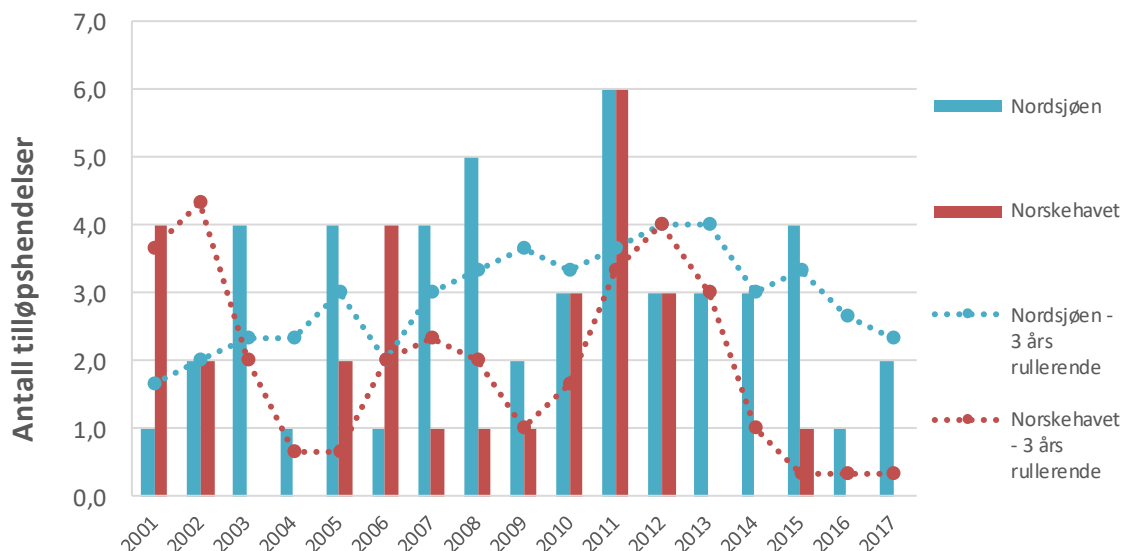
Figur 47 Antall lekkasjer og skader på stigerør, rørledning og undervannsproduksjonsanlegg innenfor sikkerhetssonen, havområder
