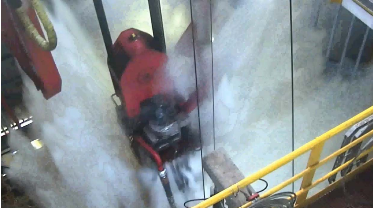
Figur 15 Utstrømning av gass og væske fra fingerbord nivå (kilde: Songa Offshore)
