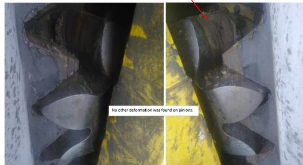
Bilde Nr. 2 Eksempel på avskalling og sprekk.
