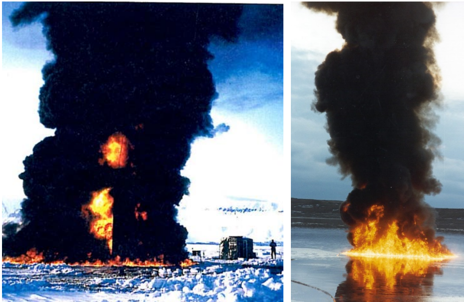
Figur 3-7: Bilder fra "Brann på Sjø"-prosjektet i 1994. Bildet til venstre er fra vintertesten med oljeflak i et hull i isen. Bildet til høyre er fra sommertesten med oljeflak på sjø. Foto: SP Fire Research.
