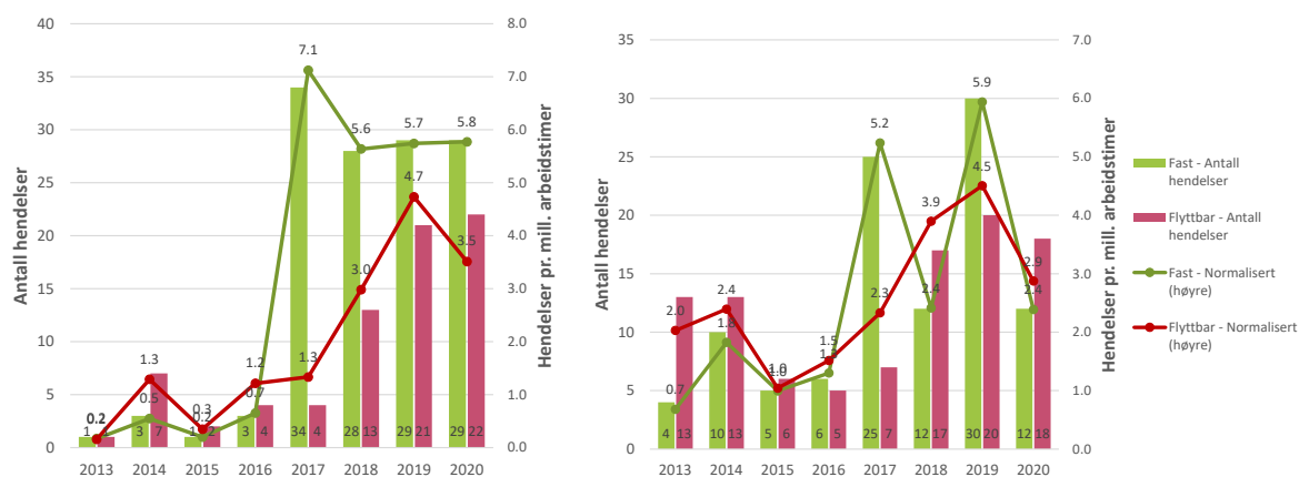
Figur 8.14 Antall hendelser i boreområder, <40 J til venstre og >40 J til høyre, fordelt på faste og flyttbare innretninger, samt normalisert mot bore- og brønntimer pr år, for perioden 2013-2020
