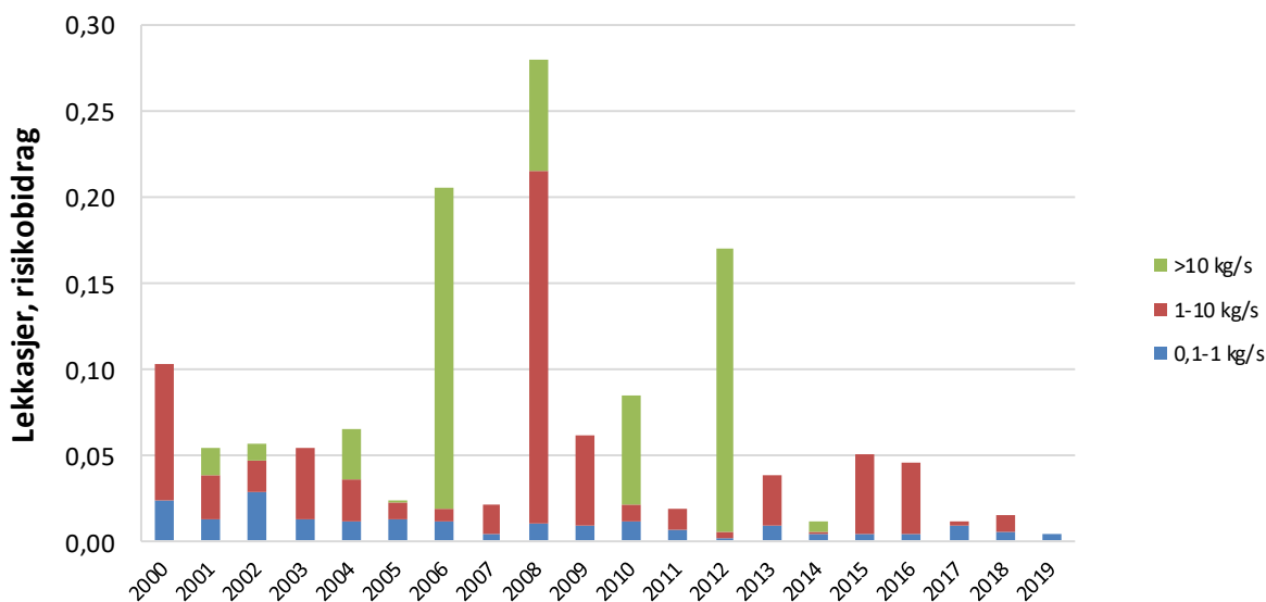
Figur 6.4 Antall hydrokarbonlekkasjer større enn 0,1 kg/s, 2000-2019, vektet etter risikopotensial
