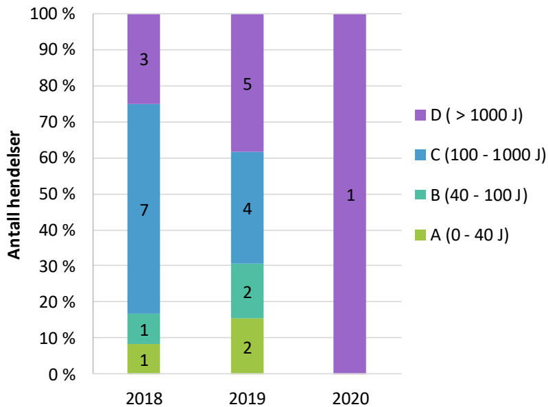
Figur 4-11 DFU20, landanlegg: Antall hendelser som involverer fallende gjenstand relatert til kran- og løftehendelser, fordelt på energiklasser og årstall (data fra 2018-2020)
