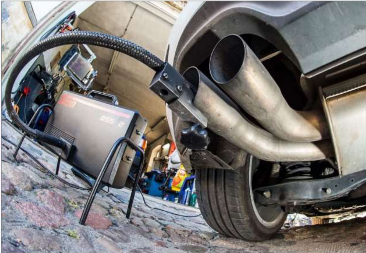
AVGASSMÅLING: Etter reparasjonen av nesten 11 millioner biler skal utslippene være i henhold til lovkravene. Her er en eksosmåling av en Golf 2,0 TDI diesel i en
