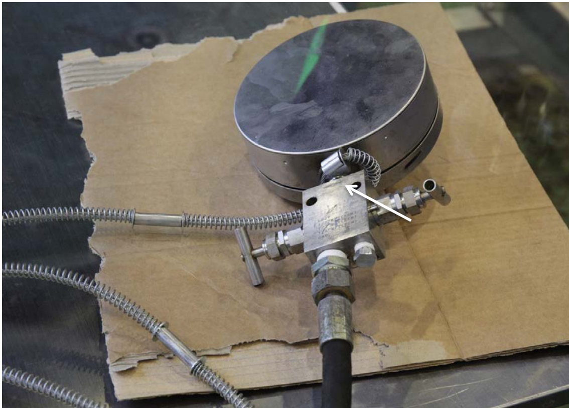
Figur 41. Trykktest med vann til ca. 135 bar. Ingen tegn til lekkasje i område med sprekkindikasjon.
