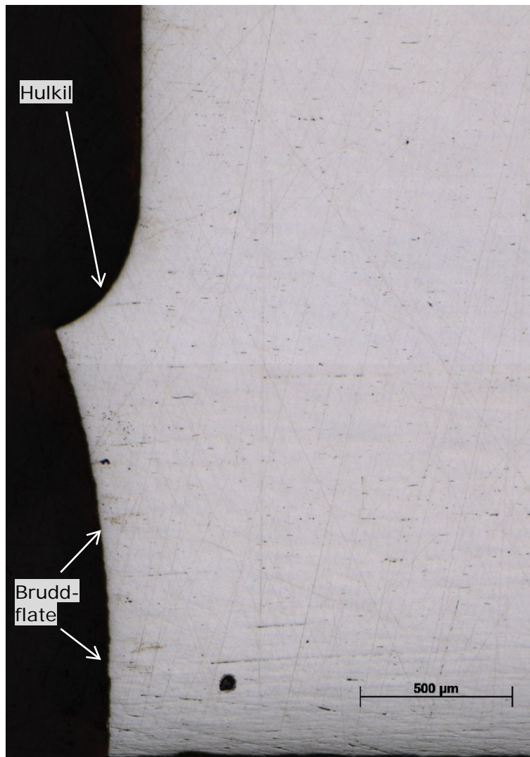
Figur 30. Metallografisk slip av male adapter, polert tilstand. Hulkil og bruddflate vises. Indre overflate viser noe deformasjonstekstur. 50x forstørrelse.
