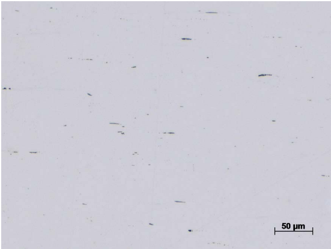
Figur 33. Polert tilstand: Noen opplinjerte innslutninger vises. 200x forstørrelse.
