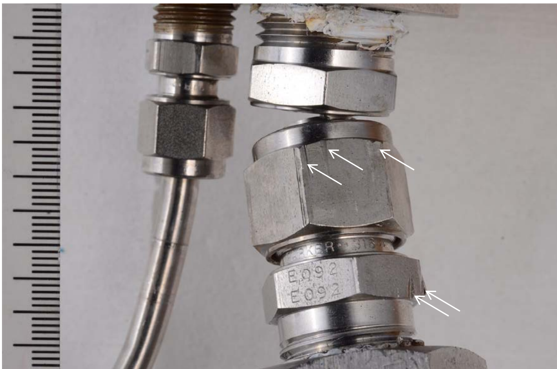
Figur 12. Nærbilde som viser verktøymerker på twin ferrule (se pil). Merk ulikt heat-nr E092.
