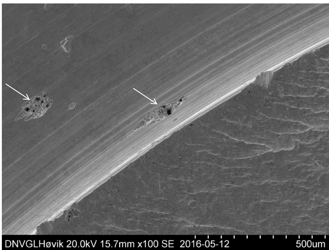
Figur 25. Antatte korrosjonsgroper i og ved hulkil. I nærheten av restbrudd. 100x forstørrelse.
