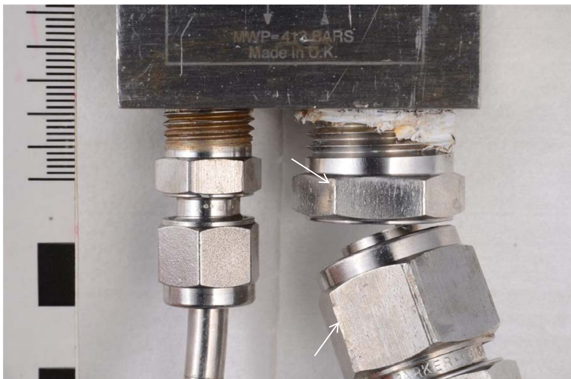
Figur 10. Nærbilde av male adapter og twin ferrule til høyre, sett forfra (mhp ventilblokk). Verktøymerker er angitt med piler.
