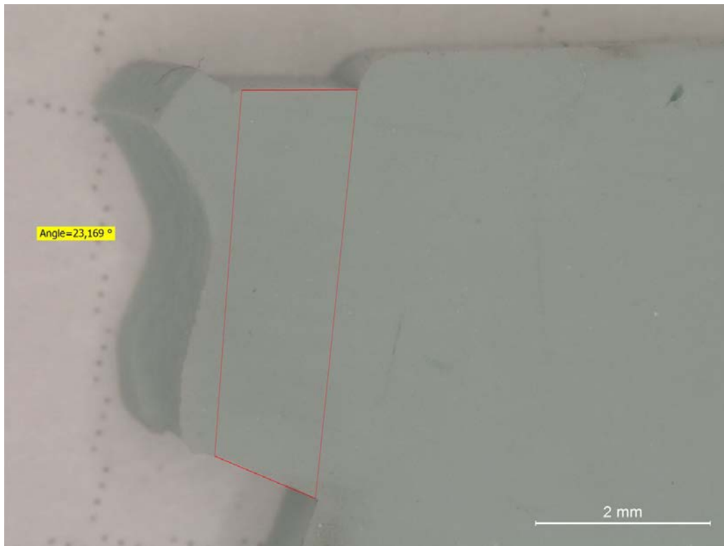
Figur 13. Avstøp av åpningsvinkelen i bruddet vha. stereomikroskop. Vinkelen er ca. 23°.
