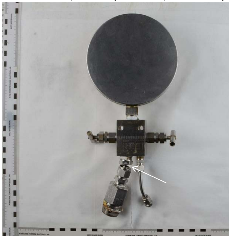
Figur 2. Oversiktsbilde som mottatt, bakside (sett fra øst, som installert). Brudd pilmerket.
