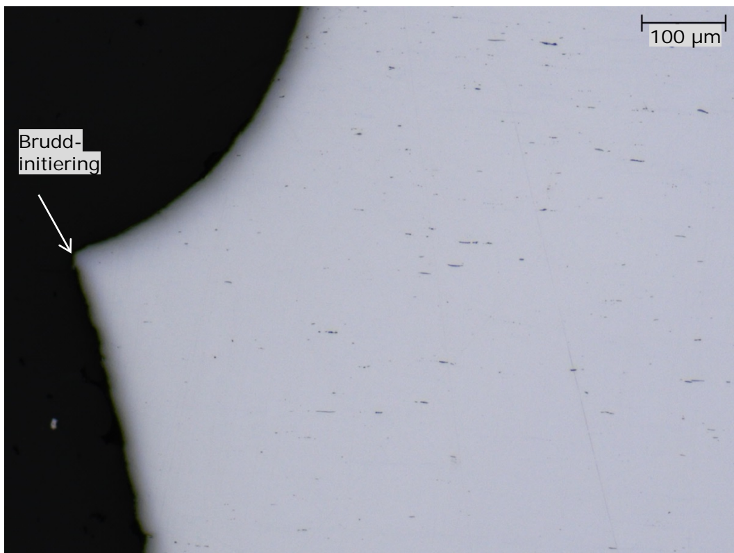
Figur 32. Polert tilstand, før etsing – ingen spesielle irregulariteter nær initieringsområde.
