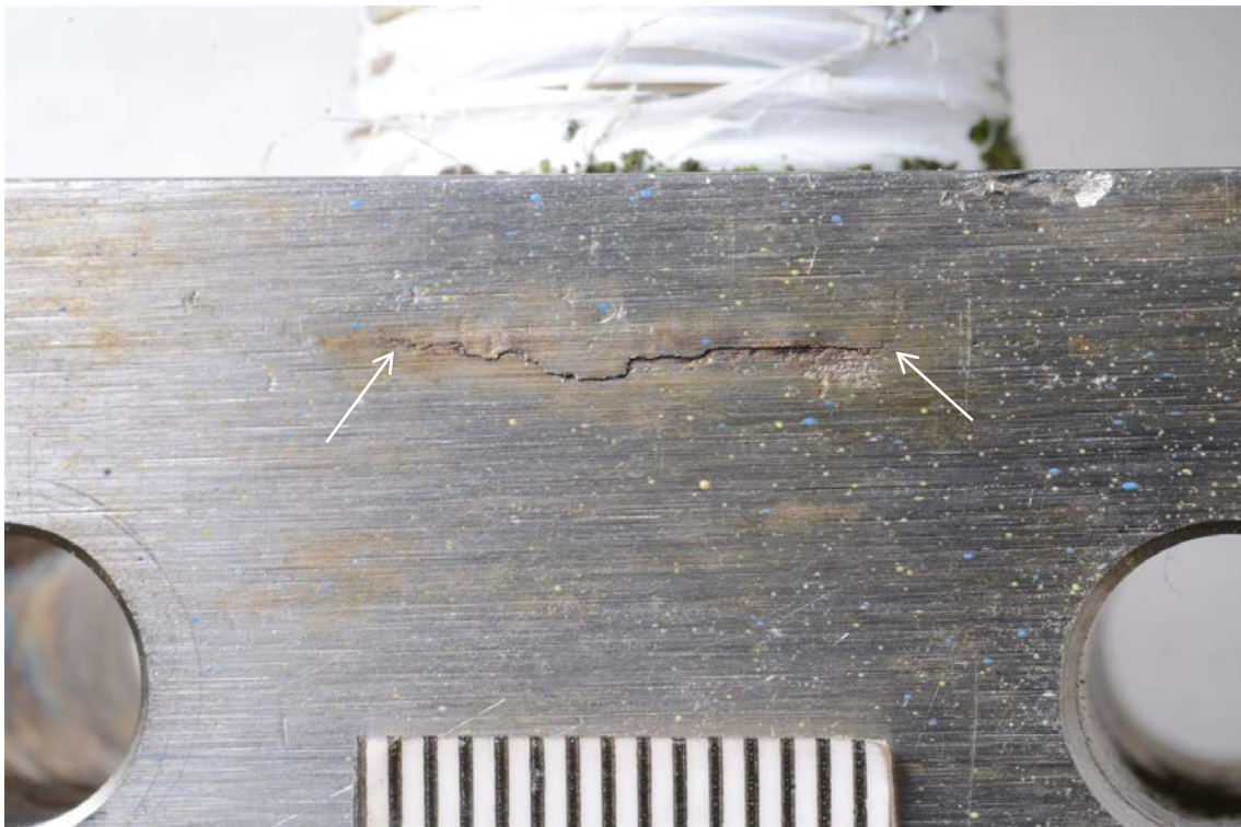
Figur 8. Ventilblokk – nærbilde av spreklignende defekt (pilmerket). Synlig lengde 14,5 mm.
