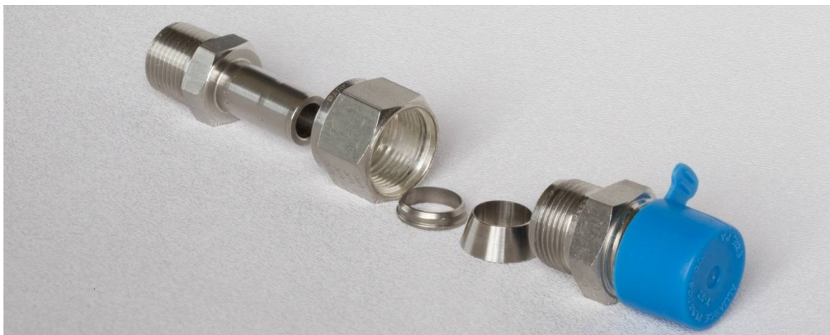
Figur 5 Eksempel på NPT Male adapter og komponenter som inngår i snittringskoblingen (Parker A-LOK®)
