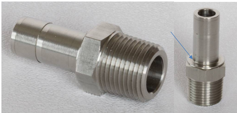
Figur 4 Eksempel på NPT Male adapter i 3/8". Pil viser hvor på denne komponenten utmattingsbruddet oppstod
