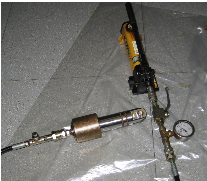
Fig 4.5 – Sagstøtte med hydraulikkpumpe
