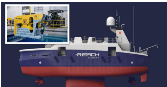
Figur 4.4: Reach Subsea med partnere er et eksempel på teknologi hvor ubemannet overflatefartøy brukes i kombinasjon med ROV. Bildet er gjengitt med tillatelse fra Reach Subsea.
