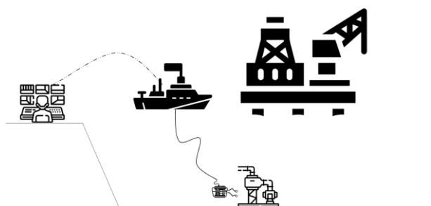
K1. Konvensjonelt ROV-konsept med IMR-fartøy. ROV er forbundet med IMR-fartøy via umbilical. ROV-mannskap om bord IMR-fartøy. Trådløs kommunikasjon til land mulig.
