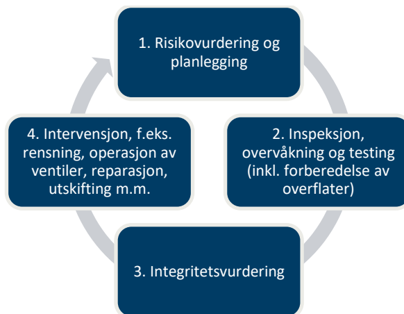
Figur 2.1: Generisk integritetsstyringssystem basert på [7].
