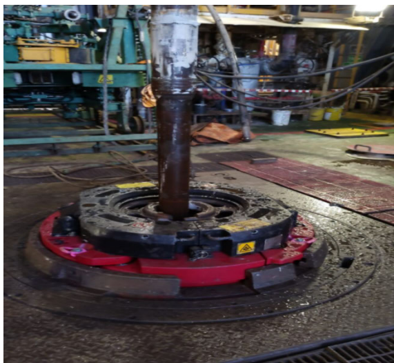
Bilde 7 PS-30 slips montert i rotasjonsbordet (kilde: Havtil)
