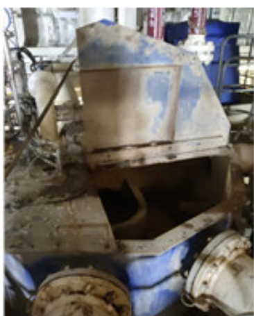
Bilde 11 Øverst på bilde er "gumboboksen" og nederst på bilde er "headerboksen" (kilde: Havtil)
