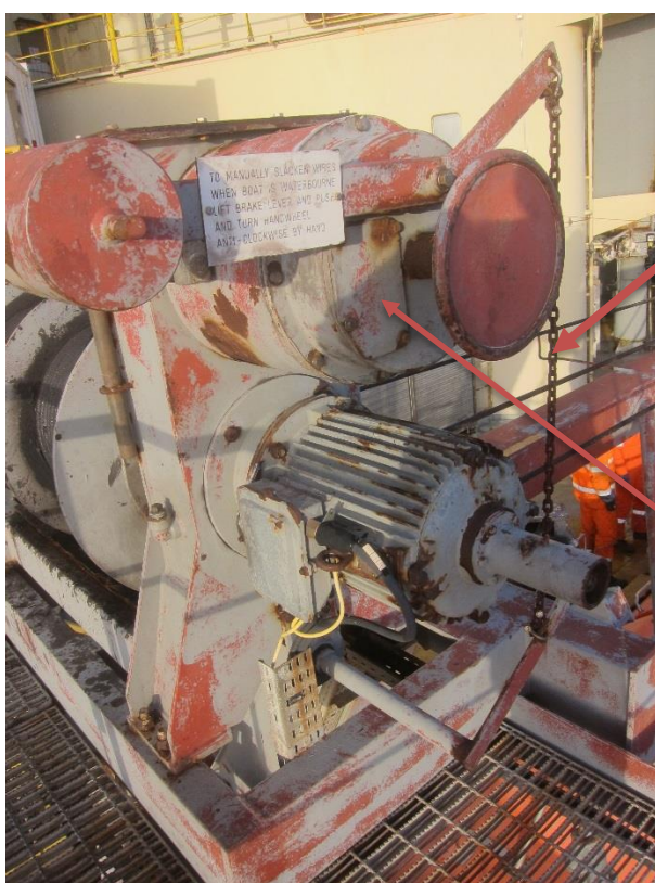
Figur 4: Tilsvarende davit på babord side med manuelt bremsehåndtak og kjetting koblet til låremekanisme
