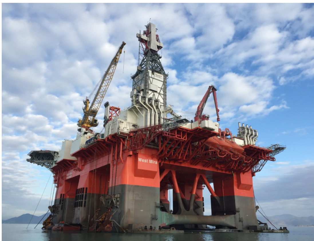
Figur 2: Bilde av den halvt nedsenkbare boreinnretningen West Mira hentet fra søknad om samtykke
