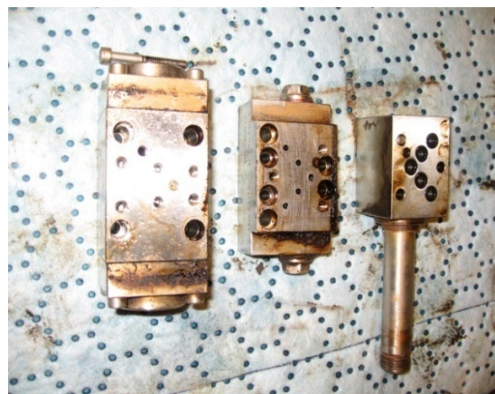
Bilde 2, hydraulisk styreblokk - demontert
