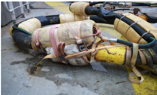
Figur 4.10 Ventilblokk og flens med ekstra beskyttelse (Foto: Politiet)
