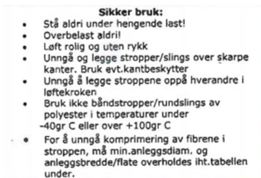
Figur 7.7 Utdrag fra bruksanvisning for fiberstropp (Kilde: CarlStahl)
