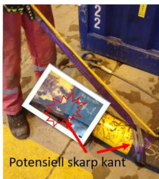
Figur 7.6 Rekonstruksjon av fiberstropp festet til slange (Kilde: KCAD)
