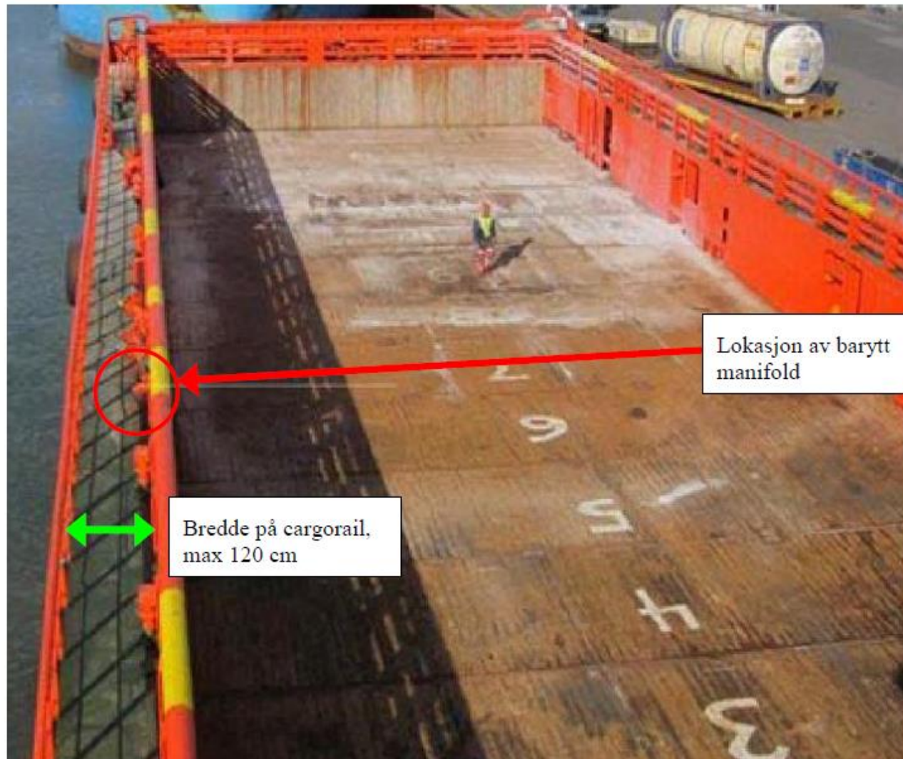
Bilde 1. Lokasjon av manifold
