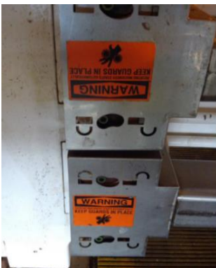
Figur 16 Indikator på at låsestang er på plass
