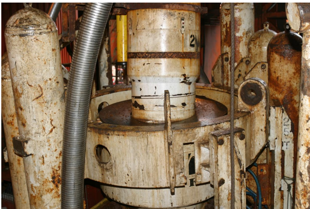
Øverste bilde viser hvordan stigerør ble sående gjennom 2spider" på boredekket. Bilde nederst viser "flexjoint" på BOP merk vinkel ca 9°.
