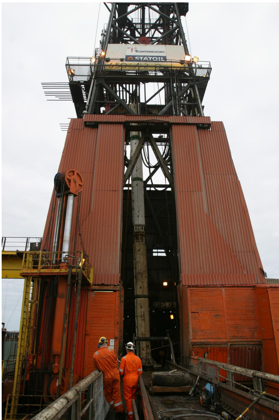
Bilde viser det 2 stigerørene slik de ble stående opp i boretårnet. Personene i bilde står i den samme posisjon som personell involvert i hendelsen.
