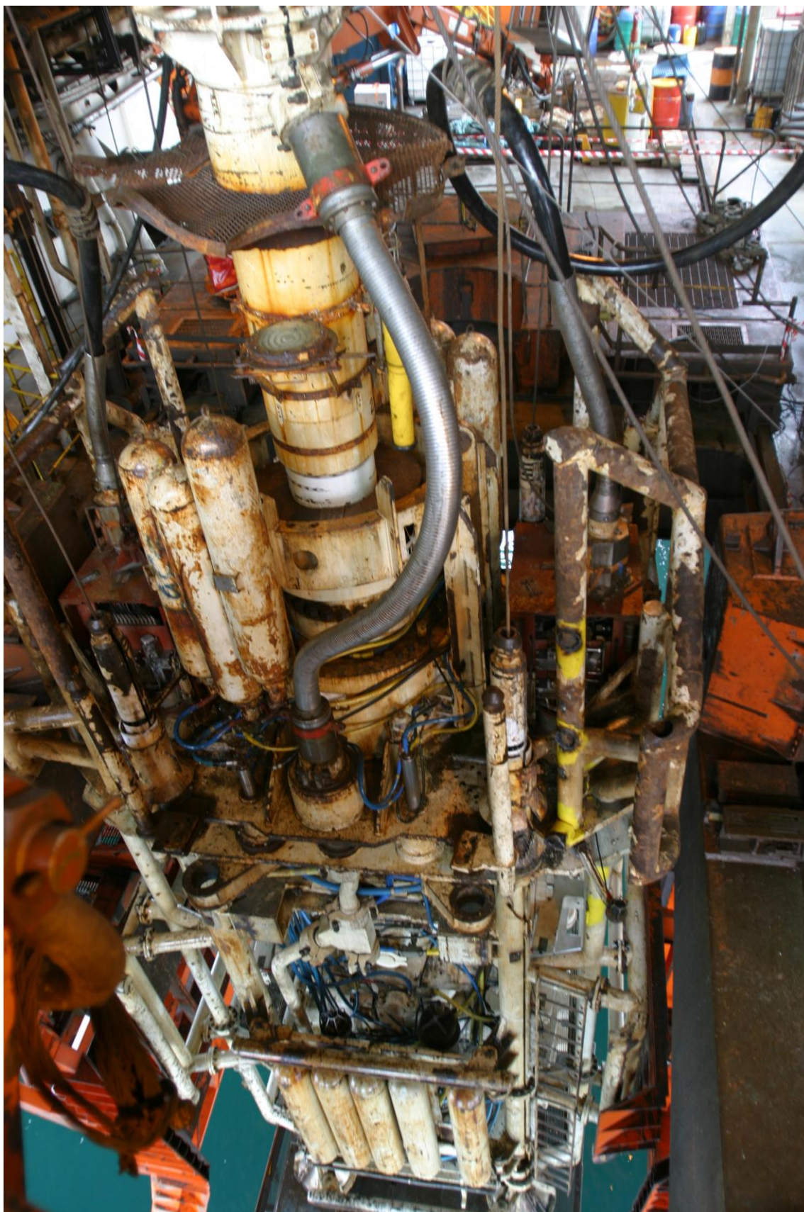
Bilde av BOP i moonpool, og deler av BOP "carrier"
