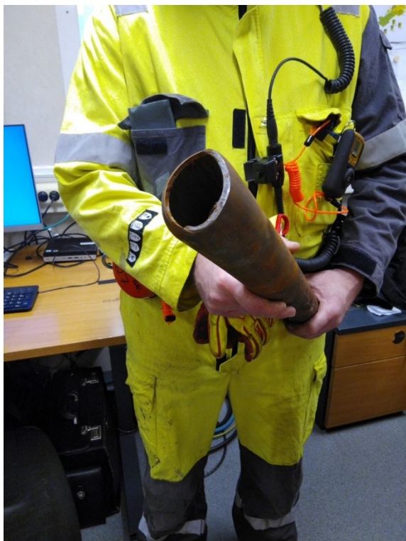
Bilde 4 - Rørstump etter kutt med CT-BOP (NOV)
