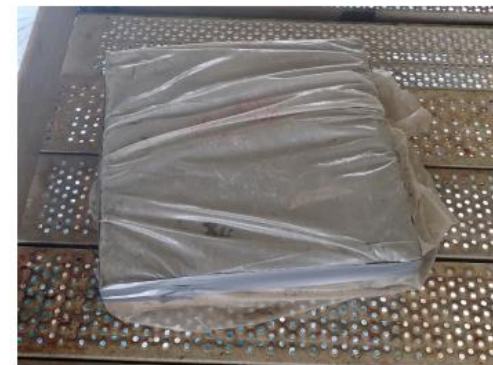
Figur 5-4: Kasse for trykkprøving ferdig sprøytet og pakket inn i plastsekk.
