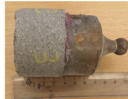
Bilde 4-39 Profil avtrekk nr. 3, prøvefelt 2
