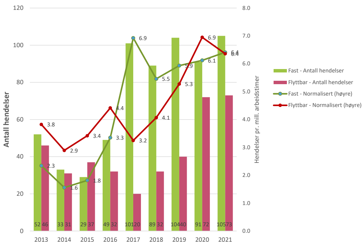
Figur 9-5 Antallet innrapporterte hendelser for kran- og løfteoperasjoner i perioden 2013-2021 vist for faste og flyttbare innretninger – absolutt antall hendelser og antall hendelser normalisert mot millioner arbeidstimer relatert til bore- og brønnoperasjoner og til konstruksjon og vedlikehold, per type innretning
