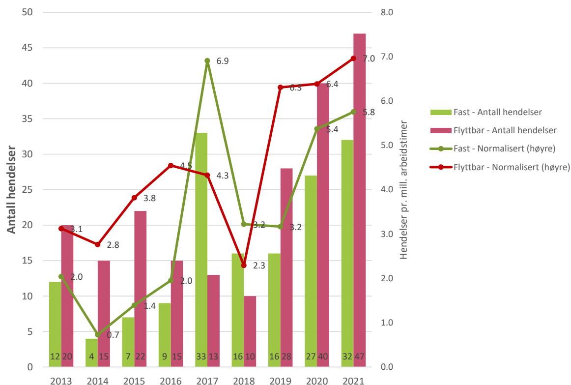
Figur 9-14 Antall hendelser relatert til Løfting i boremodul for perioden 2013-2021 vist for faste og flyttbare innretninger – absolutt antall og antall normalisert mot millioner arbeidstimer relatert til (kun) bore- og brønnoperasjoner
