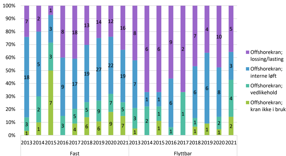
Figur 9-12 Prosentvis fordeling av hendelser relatert til Løfting med offshorekran mellom de forskjellige arbeidsprosessene fordelt på årene i perioden 2013-2021 og vist for faste og flyttbare innretninger (antall hendelser er angitt i søylene)
