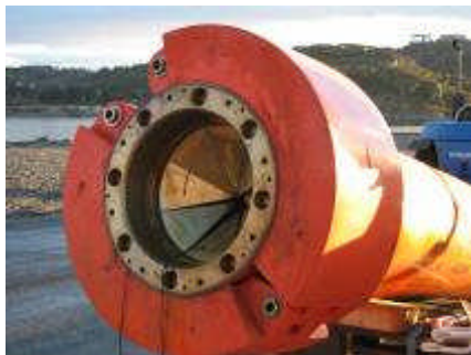
Bilde 4-4: MBC montert på delen av lasteslangen som er koblet opp mot tankskipet
