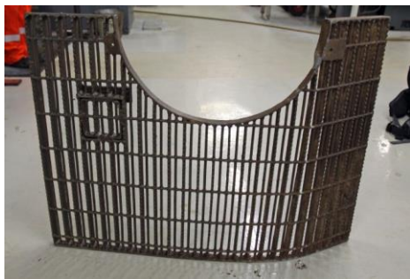
Bilde 16 Skadet dekkrist
