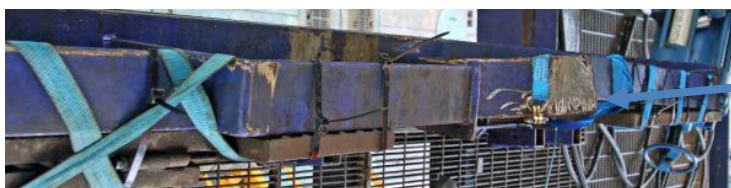
Bilde 12 Skadet dekkslukestruktur
