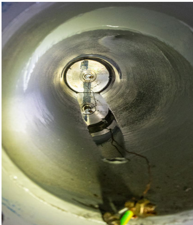
Bilde av kobberledningen i bunnen av oljerøret og dens kobling inn mot EV-tanken (bilde fra politiet).
