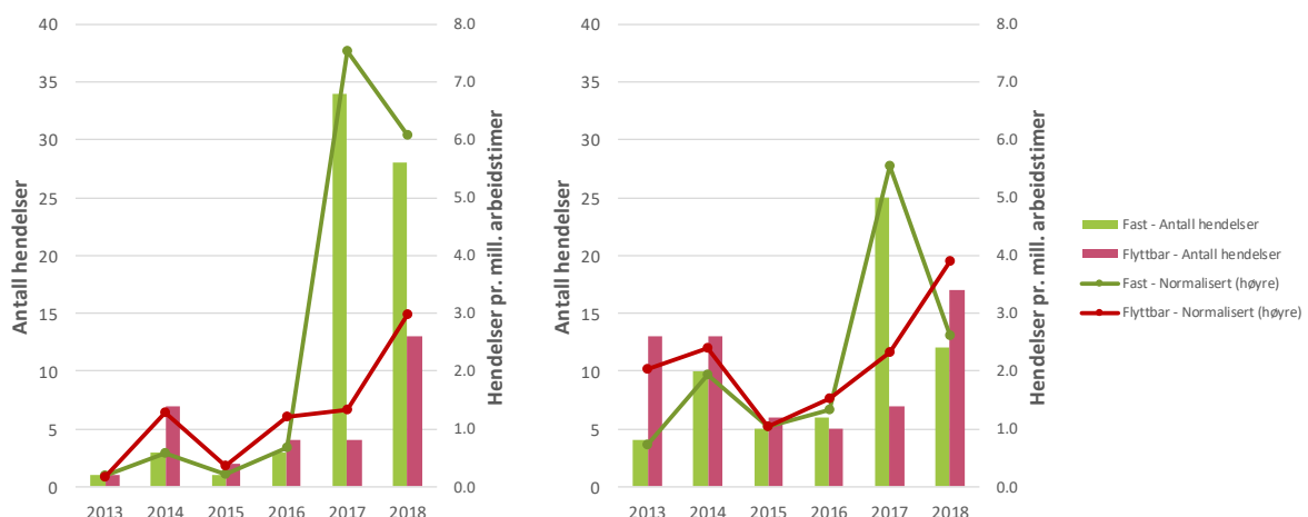
Figur 9-29 Antall fallende gjenstander i boreområder, < 40 J til venstre og > 40 J til høyre, fordelt på faste og flyttbare innretninger, samt normalisert på bore- og brønntimer pr år, for perioden 2013-2018
