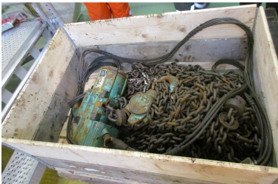
Figur 5 - Rekonstruksjon av kjettingtaljen og løftekjettingen
