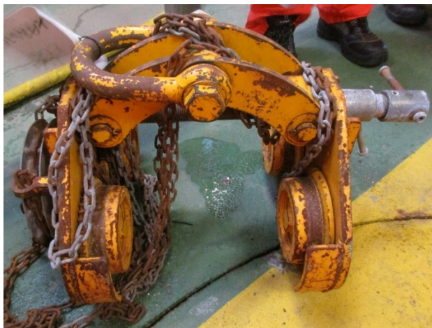
Figur 7 - Løpekatten på dekket etter hendelsen
