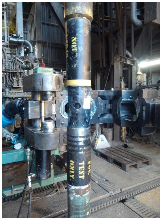
Figur 4 CCS sub påmontert borestrengen med klemme for sirkulering klar til montering
