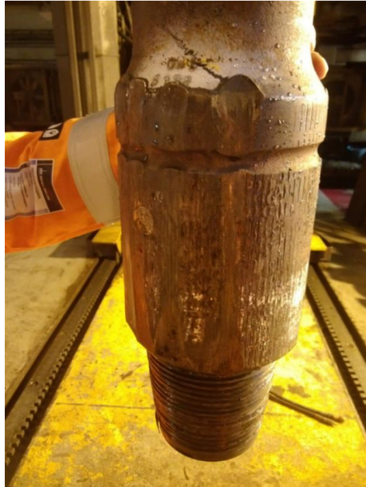
Figur 15 Viser nedre koping på fisk #2 som falt inn under brønnhode. Viser merker etter å ha passert koblingsstykker på vei ned langs fisk nr. 1. Kilde : Odfjell Drilling/ Deepsea Yantai
