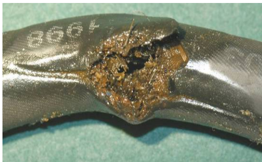
Bilde 5: Skade på hydraulikkslangen (Kilde: StatoilHydro)
