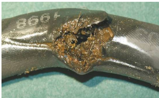
Bilde 5: Skade på hydraulikkslangen (Kilde: StatoilHydro)
