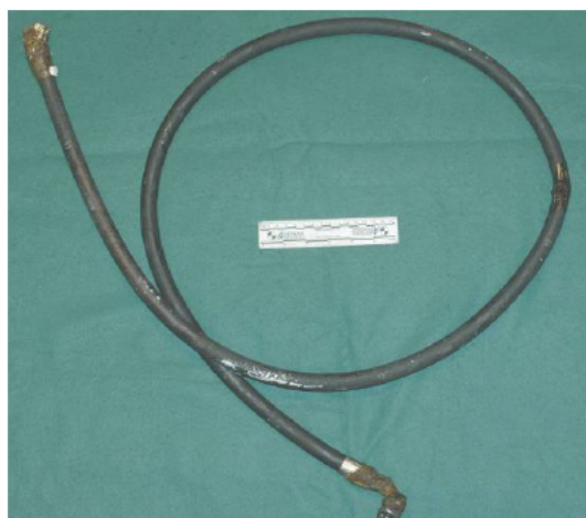
Bilde 2: Hydraulikkslangen mellom Coupler-ventilen og strømningskontrollventilen (Kilde: StatoilHydro)
