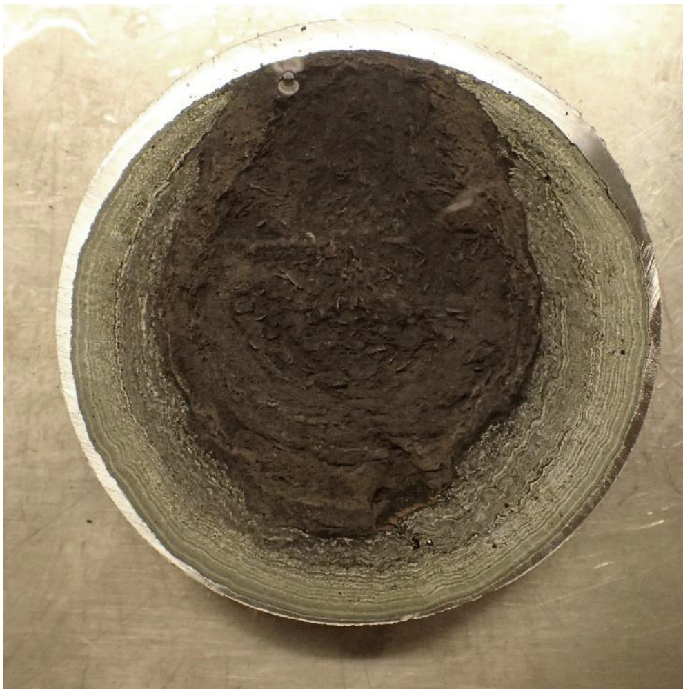
Figur 11: Tverrsnitt av horisontal del av rørsloyfen. Klokkeposisjon 12 er oppe og 6 nederst.
