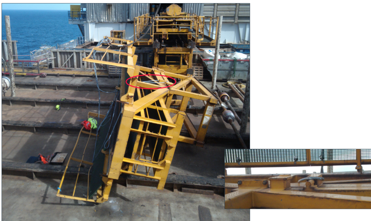
Figur 5 - Bildet hentet fra Equinor sin presentasjon av hendelsen som viser strukturen hvor ståltastroppen huket seg fast.
