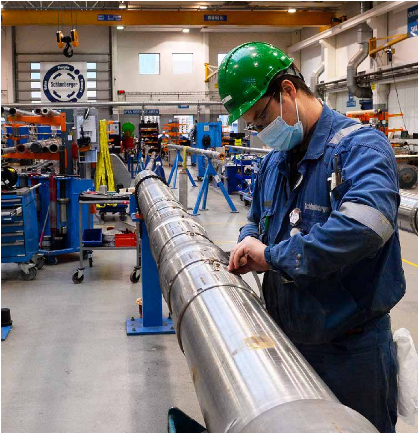
Bjørn Harald Flaten sjekker at det elektroniske utstyret inne i borestrengen fungerer som det skal. (Foto: Jonas Haarr Friestad)
