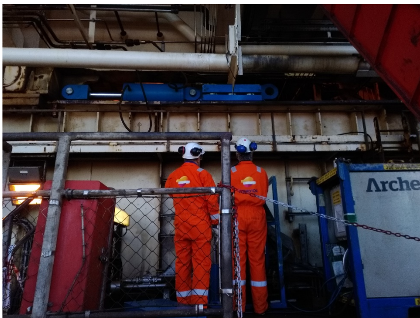
Figur 3: Rekonstruksjon med plassering av personell i hendelsestidspunktet. Gripesystemet over er uten sideplate.
