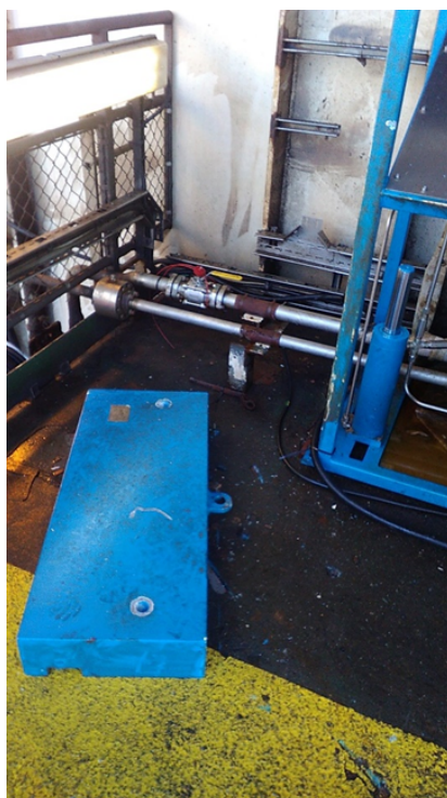
Figur 7: Bildet over viser sideplaten på 480 kg der den falt til ro på dekk rett ved operatørstasjonen.
