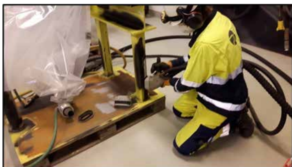
Figur 3-6 Demonstrasjon av Pinovo på teststasjon hos produsent Øverst; blåse og vakuum enheten. Høyre; håndholdt rørblåseverktøy. Nederst tv.; avlukke for sandblåsing med oppsamling av sand og malingrester ved komplekse rør- og bjelkestrukturer.
