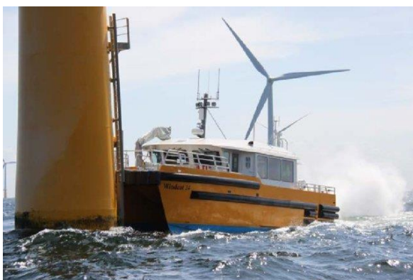
Figur D-1 «WindCat-fartøy» som overfører personell til en vindturbin. Kontakten innebærer i gjennomsnitt en periode på ca. 5 til 10 minutter, men kan forlenges når utstyr må overføres. Etter overføringen holder fartøyet seg i nærheten. Overføringen av personell fra vind turbinen til WindCat skjer i motsatt rekkefølge (de Haan med flere, 2013)
