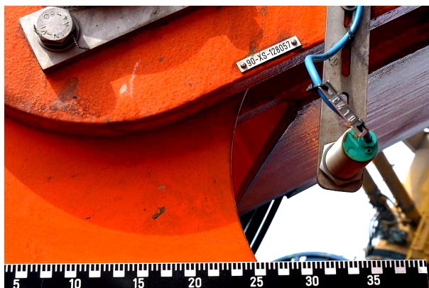
Bilde 13 viser plasseringen av grensebryter for bomvinkel.
