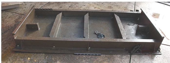
Bilde 6: "Dropped object"-luka som falt ned på VFN.
