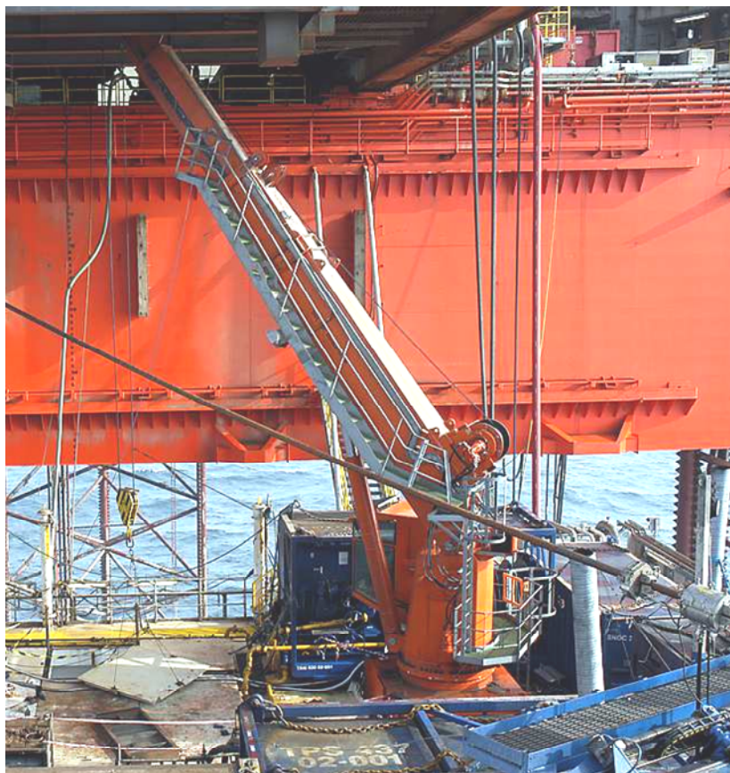
Bilde 2: SIMOPS-kranens plassering på VFN i forhold til WE. "Dropped Object"- luka og brønnluka ses nede til ventre
