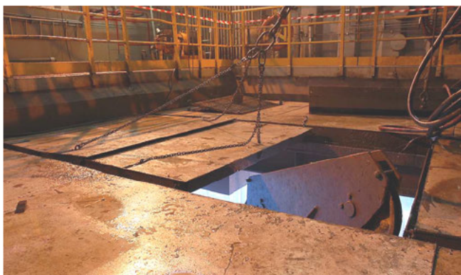
Bilde 1: Lukearrangementet på BOP-dekket på WE
