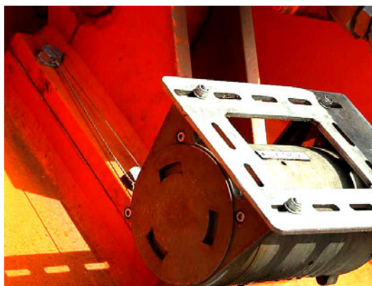
Bilde 14 viser transmitter for lengdemåling av teleskoputslaget.
