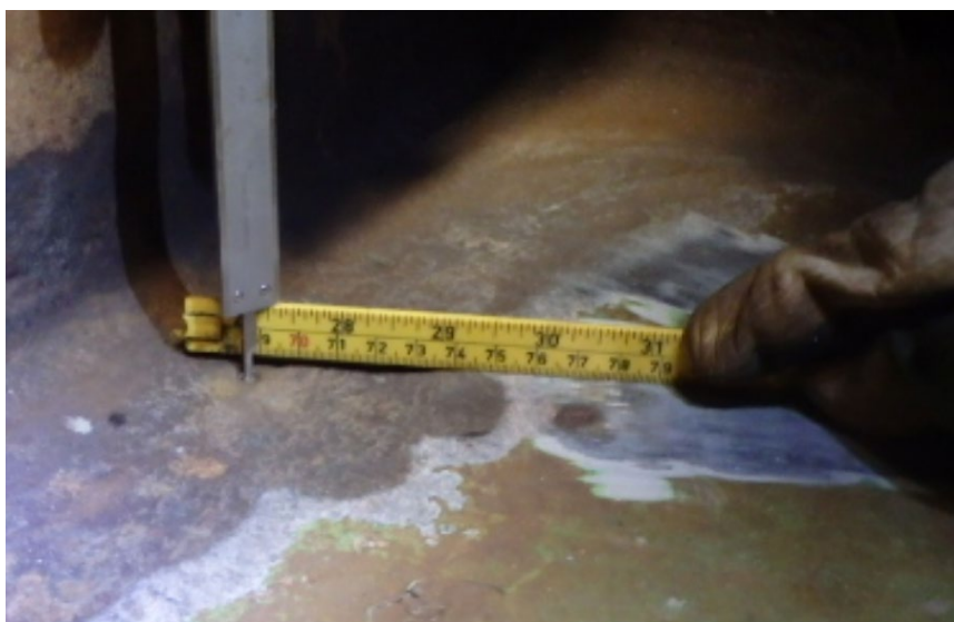
Figur 5-32 Eksempel på tap av godstykkelse
